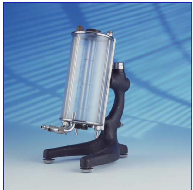
Abb. 7: Funktionsweise eines Kugelfallviskosimeters
