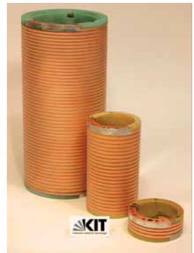
Einlagige REBCO-Solenoid-Spulen für die Experimentieranlagen JUMBO und HOMER I am ITEP
