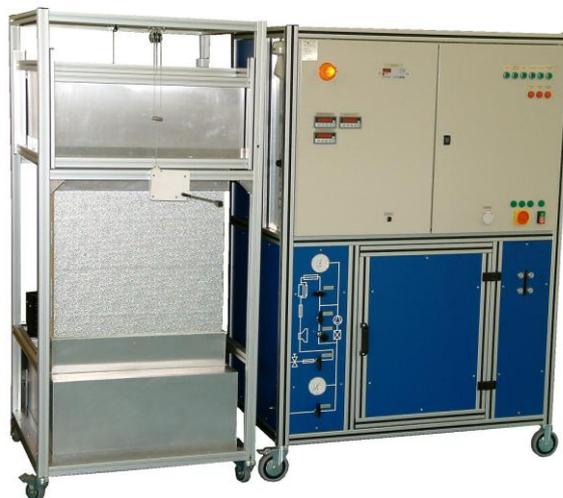
Verdampferkalorimeter am ITTK
